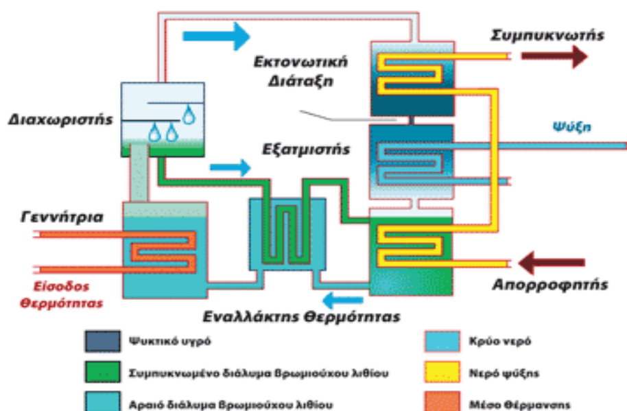
Σχήμα 24 Αρχή λειτουργίας ενός ψυκτικού συστήματος απορρόφησης μονού σταδίου. [7]
