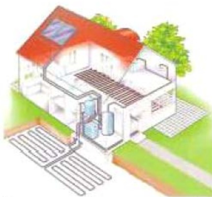
Υβριδικό σύστημα θέρμανσης – ψύξης με γεωθερμία και ηλιακή ενέργεια
